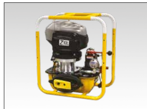
▲ Le RP70A peut être transporté en toute sécurité dans un châssis de transport en acier spécifiquement conçu, pouvant également et simultanément contenir et protéger un ensemble pompe et flexible.
