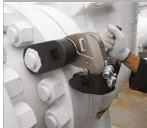
▲ Clé dynamométrique S11000X personnalisée au moyen d'un manchon de serrage et d'une roulette de réaction.
