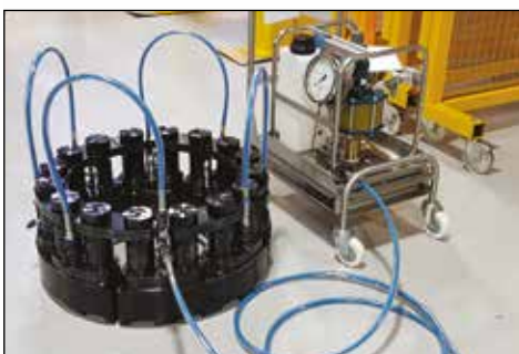
◀ Système Enerpac de mise en tension multigoujon (MST) permettant de serrer tous les goujons d'un joint en même temps.
